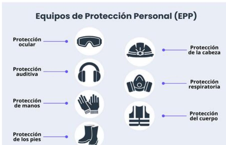
Figura 2.1. Equipos de protección personal (EPP).
