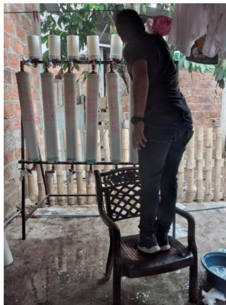
**Foto 14.** Ensamblaje y etiquetado de filtros
