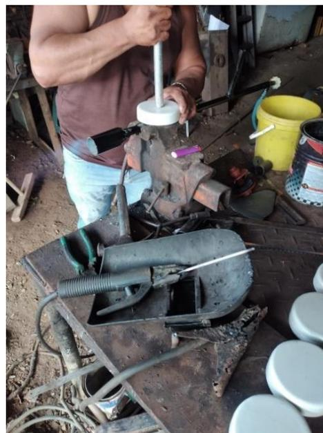
**Foto 8.** Perforación de la tapa Ciega (a una medida de media pulgada)
