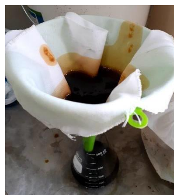
Anexo 1-C. Filtración del aceite
