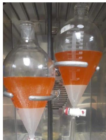
Anexo 3-F Lavado final del biodiesel
