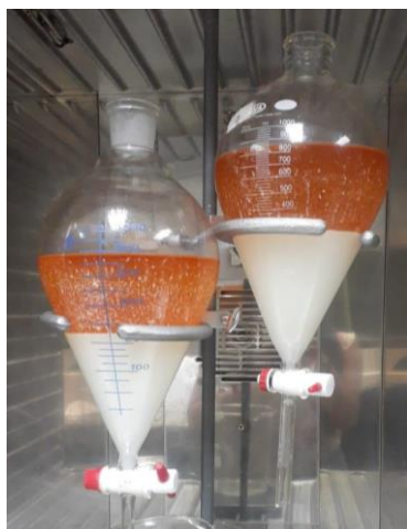
Anexo 3-E Lavado del biodiesel
