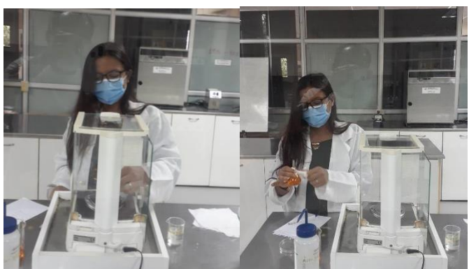
Anexo 4-A. Análisis de densidad del biodiesel.
