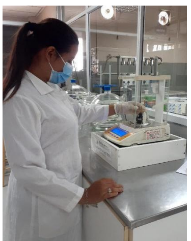
Anexo 2-A. Análisis de densidad con pignómetro.
