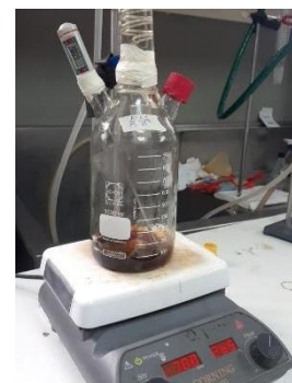
Anexo 3-C. Proceso de transesterificación
